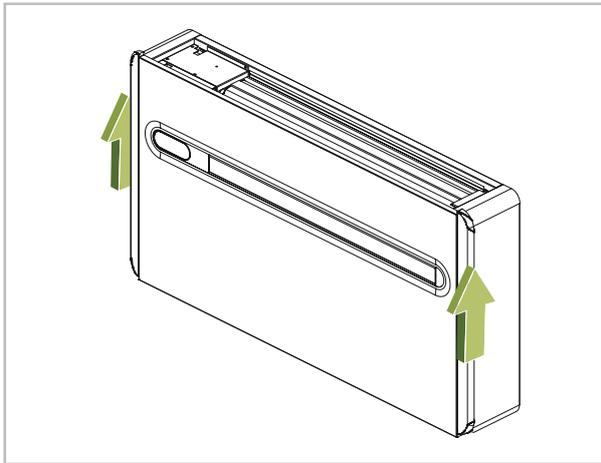
**3.** Die Seitenleisten nach oben ziehen und entfernen.
