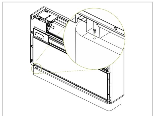
**7.** Die Sockelblende mit den Linsenkopfschrauben an den Bodenkonsolen verschrauben.
