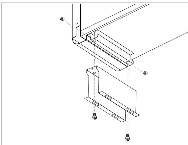
**5.** Die Muttern in die geräteseitige Schienen schieben und die Bodenkonsole mit den Zylinderschrauben von unten befestigen.
