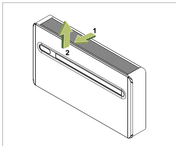
1. → Das Ansauggitter nach vorne ziehen [1] und anschließend von oben entnehmen [2].
