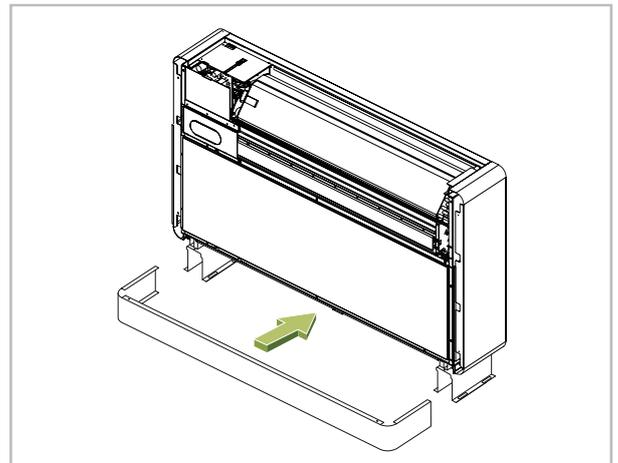
**6.** Die Sockelblende vor das Gerät setzen, sodass die Blende auf den Bodenkonsolen aufliegt.
